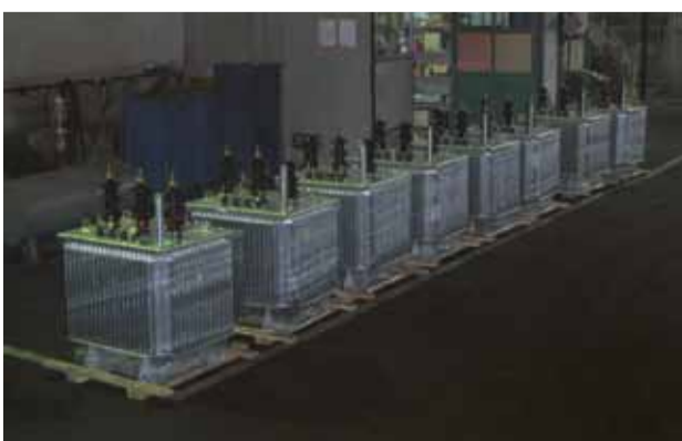
Трансформатори са Петерсеновом пригушницом ТРН 50-20,5
